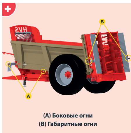
Отражательные панели, регулируемые по ширине в зависимости от колес, для соблюдения дорожного регламента.
